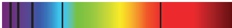
Figura 3.5 - Espectro de absorção do hidrogênio. A luz incidente na amostra tem um espectro contínuo, em que todos os comprimentos de onda estão presentes. A luz que deixa a amostra e é analisada pelo espectrômetro tem alguns comprimentos de onda atenuados ou ausentes.
