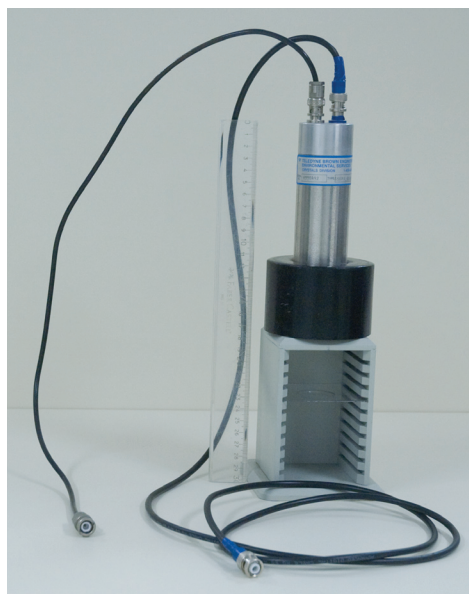
Figura 4.8 - Detetor de um espectrômetro de fótons. O conjunto cristal-fototubo fica dentro do invólucro de alumínio. Na parte superior encontram-se os conectores para o cabo de alta tensão e para o cabo de dados. O conjunto está sobre um suporte com prateleiras para o posicionamento das fontes radioativas.
